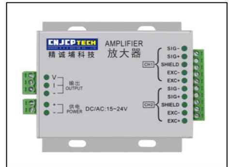
B8932 放大器采用铝合金外壳,内部采用原装进口高性能器件,将传感器输出信号进行精密放大,内部进行稳压,恒流供桥、电压电流转换、阻抗适配、线性补偿、温度补偿等。将力学量转换成标准电流、电压信号输出,可切换 0-10mA 0-20mA 4-20mA 0~±5v 0~±10v。可直接与自动控制设备 PLC 单片机 上位机终端等接口或者计算机联网。具备标准信号外调零、外调增益功能,输入过压保护,输出短路保护。
