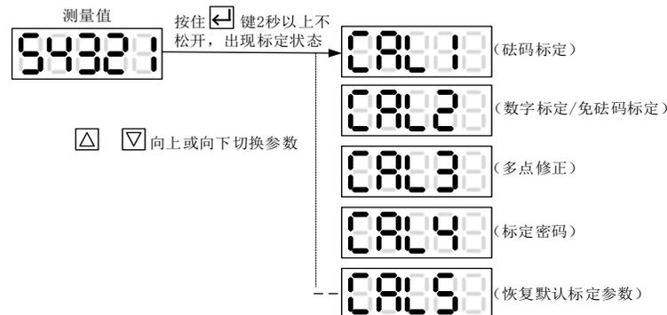
**CAL 1: 砝码标定**—采用实物标定的方法。零点标定时传感器空载，增益标定时加载实物测量满量程。
